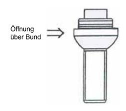
Lackierte Radsicherungen haben eine rutschige Oberfläche. Hier hilft es, die Hülse zwei bis dreimal leicht aufzuschlagen, bis die Farbe mechanisch abgetragen ist.
